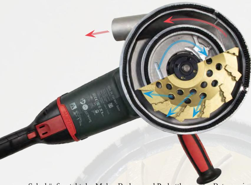
In der Multifräse compact 180 wurde erstmals die Jetstream Technologie umgesetzt. Hierbei wird ein Teil der vom Motor ausgestoßenen Kühlluft gezielt an den Diamantsegmenten des Werkzeuges vorbeigeleitet, um diese zu kühlen und den Staubabtrag zu unterstützen.
